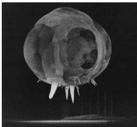
Рис. 31. Вид облака взрыва через 1 мс после детонации ядерного заряда, время экспозиции 1 мкс
